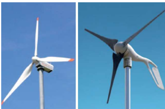
Rysunek 18 Turbiny o poziomej osi obrotu 181
